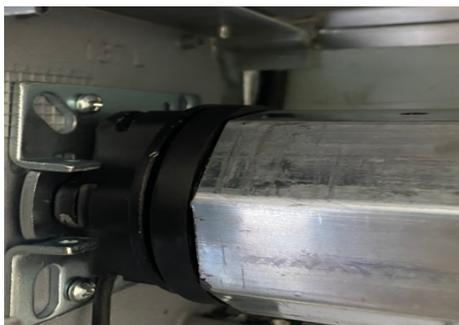
**Nota:** Es muy importante que este elemento esté bien colocado, puesto que se encarga de contar las vueltas que realiza el motor, y permite la función de los finales de carrera
